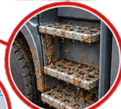
SCALA DI ACCESSO ALLA CABINA
